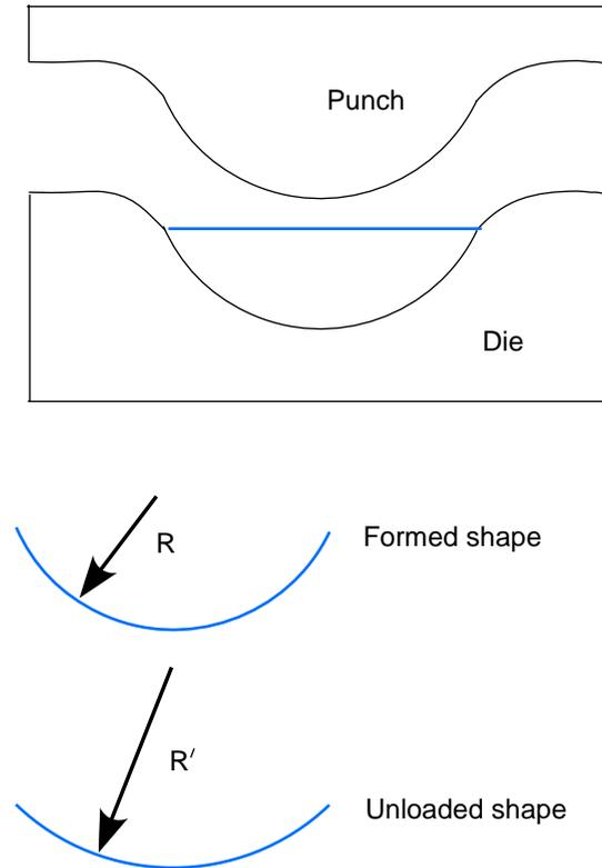
Fig. 3. Arc-bending test.
